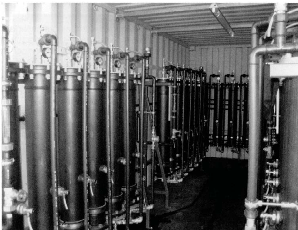
Abb. 3: Blick in eine Pilotanlage der Cornelsen Umwelttechnologie GmbH mit standardisierten Säulenteststrecken zur vergleichenden Beurteilung verschiedener Adsorbentmaterialien
